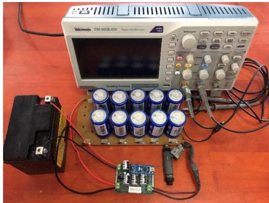
Hình 4.3: Thực nghiệm khả năng đáp ứng của kim phun Các thông số của kim phun gồm: Điện trở: R = 14,5\Omega , Độ tự cảm: L = 0,02H . Hình 4.4 và 4.5 biểu thị đường đặc tính dòng điện và điện áp của kim phun ở mức điện áp 12V từ ắc quy và khi dùng siêu tụ 24V.
