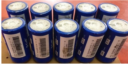
Hình 3.10: Hệ siêu tụ điện 27V-35F
